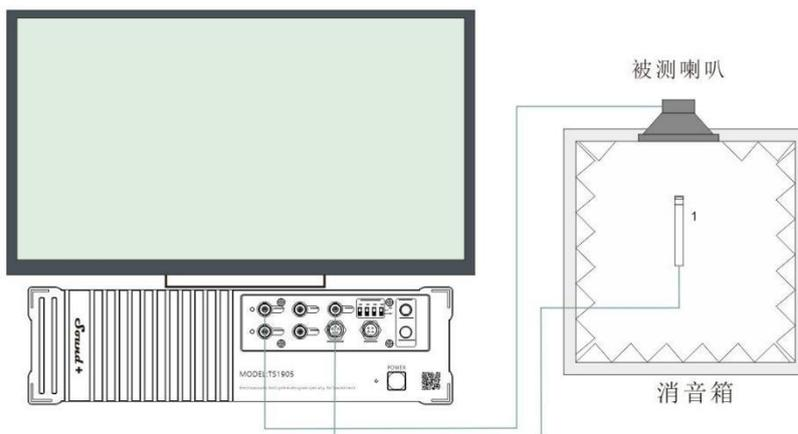
图中 1>测量麦克风，如我们的型号 MP1273A。
