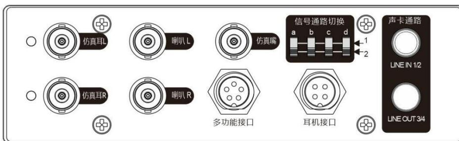
1, 仿真耳 L--这个端口是 BNC 母座，供接入 CCP, ICP, IEPE 等供电方式的麦克风或仿真耳，若接入仿真耳，这个端口即为接入的左声道仿真耳。若测试扬声器，此处接入标准测量麦克风。
