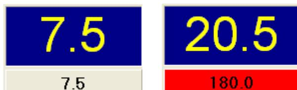
当前转动角度显示（上面），和下一个将要转动的角度显示（底部），转盘旋转到时由红色的字体突显。
