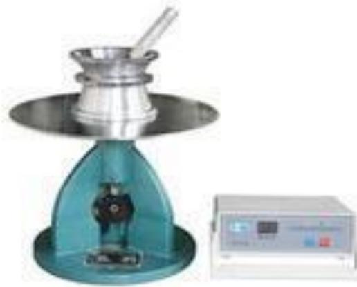
图 9 水泥胶砂流动度测定仪
