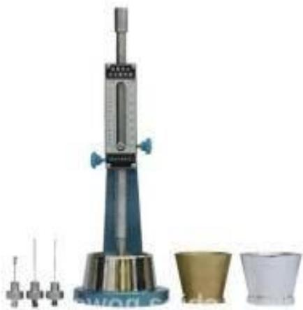
图 1 净浆标准稠度与凝结时间测定仪
