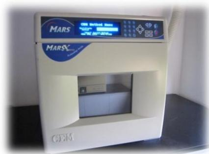
微波消解仪是化学实验室的一种常用设备，适用于各种样品的前处理。其工作原理是利用微波对极性物质的“内加热作用”和“电磁效应”。具有加热迅速，能提高样品的消化速度和效果。在消解过程中，样品温度和加热功率是其两个最重要的指标。但是由于微波消解仪加热方式的独特性一般温度传感器无法测量内部样品温度，只可以选择光纤温度传感器或红外温度计，光纤温度传感器现阶段技术还不成熟，测量准确度还比较低，而红外温度计由于隔着玻璃门测量内部样品温度也不理想。而且微波消解仪工作时需要封闭，因此有线的温度传感器也无法放进去。那怎么解决呢？其实可以通过校准微波消解仪内部
