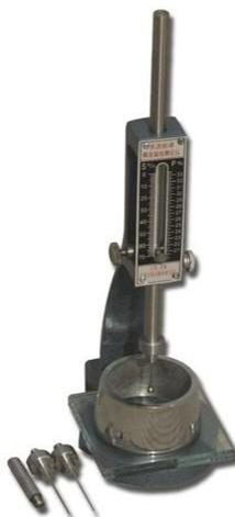
图 2 净浆标准稠度与凝结时间测定仪
